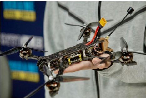
"Vår" Race Drone FPV är egentligen konstruerad för hastighetstävlingar. I taktiska sammanhang flyger de snabbt över trädtopparna och är mycket svåra att skjuta ner.
